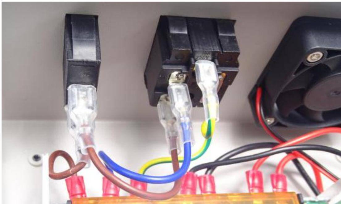
⑥ Тестирование внутреннего БП: еще раз проверьте подключение проводов и включите внутренний БП, с помощью тестера-пробника проверьте наличие питания. Затем проверьте мультиметром наличие 60V на выходе БП и с помощью отвертки установите 65V.
