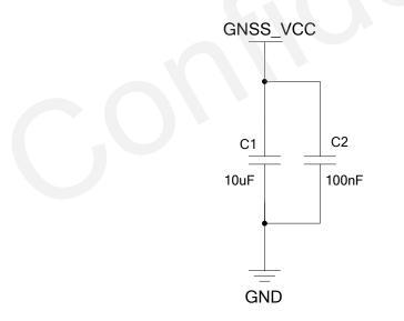
Figure 7: Reference Circuit for the GNSS\_VCC Input
