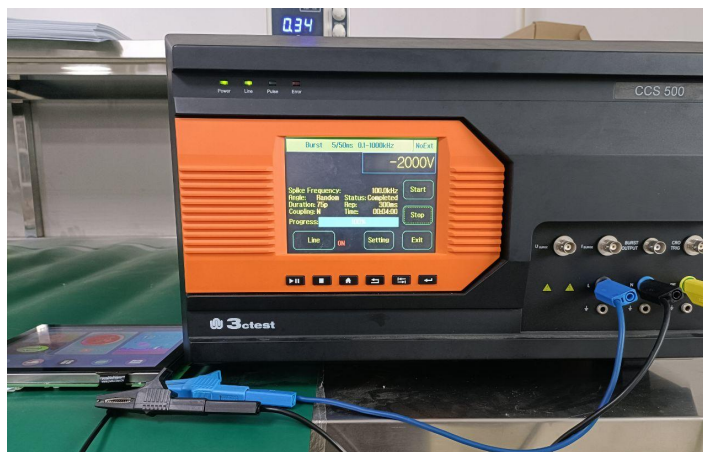
3.2 群脉冲测试图 EFT test
