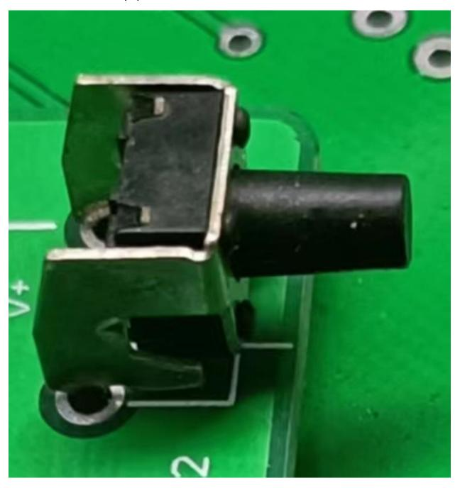
Аудио система с Bluetooth имеет элементы ручного управления, которая состоит в том числе из трех тактовых кнопок. Каждое место на плате с тактовой кнопкой промаркировано соответствующим обозначением — К1, К2 и К3. Установите все тактовые кнопки так, как показано на рисунке. Для увеличения размеров нажимного язычка кнопки воспользуйтесь специальными пластиковыми колпачками.
