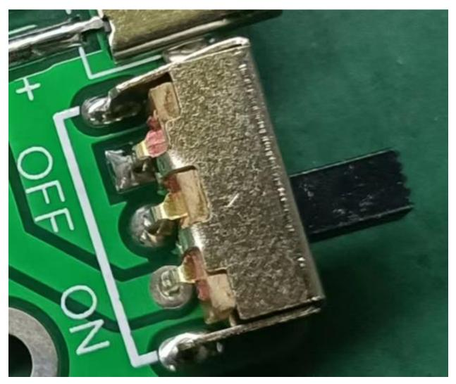
Установите переключатель 2-позиционный (тумблер) 5-контактный на плату в место с маркировкой SW1 так, как показано на рисунке. Рычажок тумблера должен немного выходить за край печатной платы, что бы им удобно было управлять. Припаивайте тумблер максимально близко к поверхности платы.
