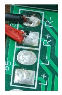
USB Bluetooth стерео аудио колонка обладает функцией двухканального воспроизведения звука. Динамики левого и правого каналов имеют одинаковые нагрузочные характеристики: сопротивление 4 Ом, выходная мощность 3Вт. К входным контактам каждого динамика припаяйте по два провода — красный к «+» и черный к «-». Если полярность на динамике не указана, то цвет изоляции провода не имеет значения.
